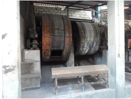
Gráfico N. 21: Tambores del Área de Recurtido. Fuente: Investigadora
