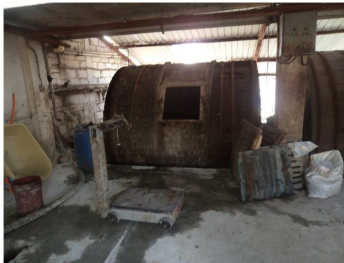
Gráfico N. 14: Tambor para el Proceso de Pelambre Fuente: Investigadora
