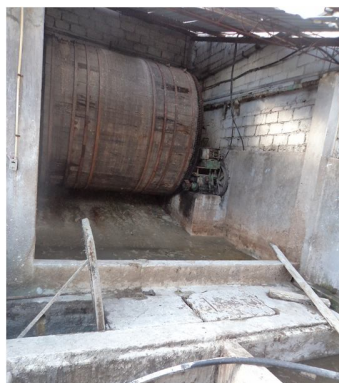
Gráfico N. 15: Proceso de Pelambre Fuente: Investigadora
