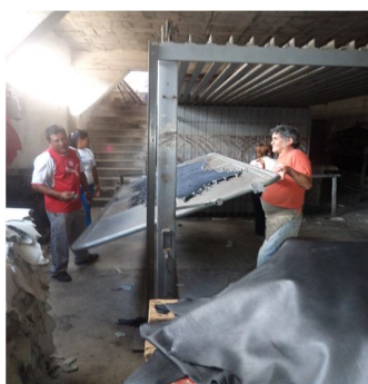
Gráfico N. 25: Máquina Toogling. Elaborado por: Investigadora
