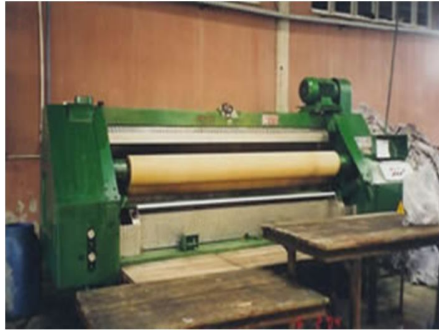
Gráfico N. 19: Máquina Escurreidora. Fuente: Investigadora
