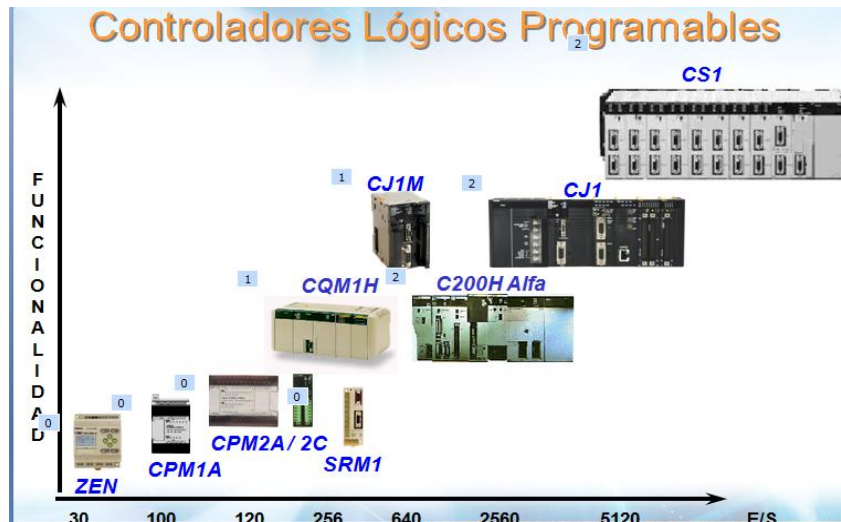
Fig.1. Tipos de controladores lógicos programables
