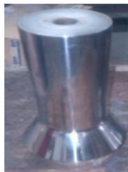
Figura 6.1 Cono para elaborar tubería de desagüe 110 mm
