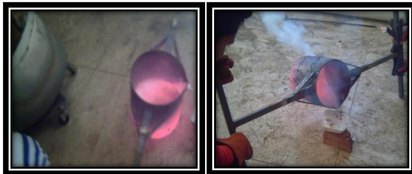
**Figura 6.25 Aluminio fundido y colocación en el molde por el bebedero**
