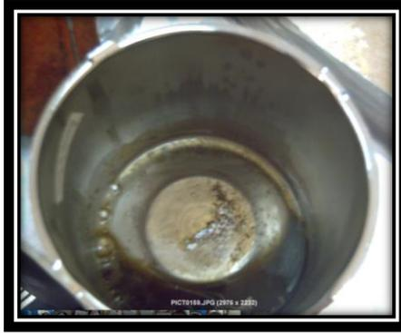
**Figura 6.24. Obtención de la cera al momento en que se está secando el molde**
