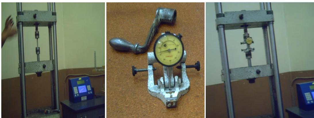
**Figura 6.31. Acoplamiento de la probeta en la Máquina Universal Tinius Olsen capacidad de 30 toneladas**
