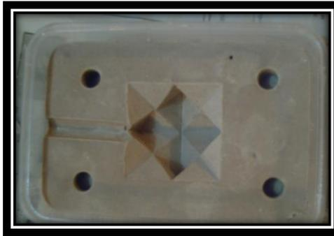
**Figura 6.17 Obtención del negativo de la figura**
