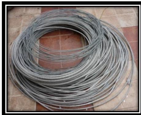
**Figura 6.4. Aluminio Electrolítico (cables de luz)**
