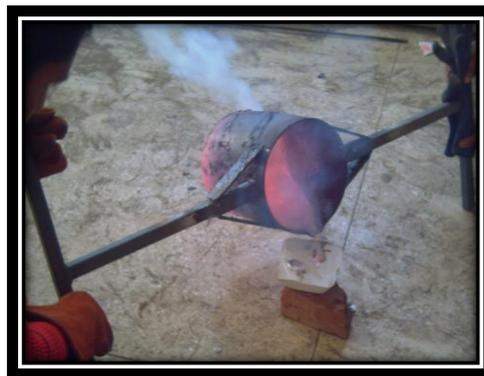
**Anexo A1.6 Colocación del aluminio fundido en el molde**
