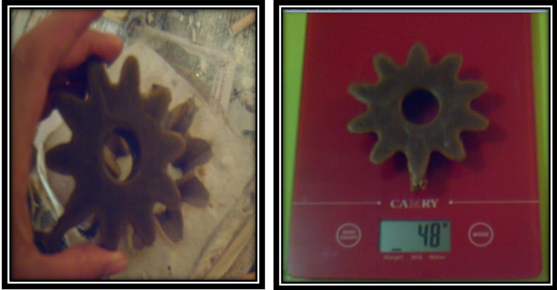
**Anexo A2.12** Peso de la pieza en cera perdida para determinar cuanto de aluminio se va a fundir
