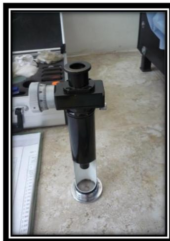
**Figura 6.41. Medidor manual FICM**
