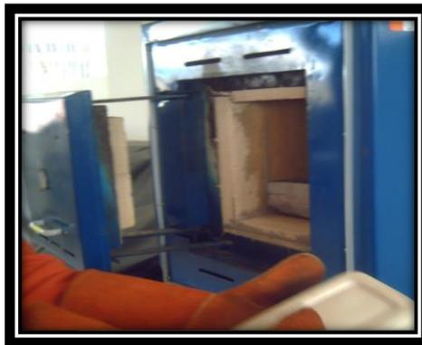
**Figura 6.23 Secado en el Horno de mufla**
