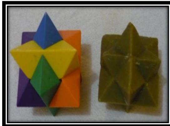
**Figura 6.16 Diseño de figuras complejas en cera perdida**
