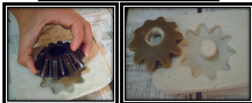
**Figura 6.6 Molde en yeso de la pieza mecánica**
