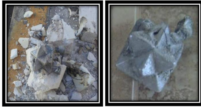
**Figura 6.26. Rotura del molde de yeso y se obtiene la figura deseada**
