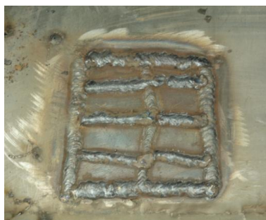
Figura 5.9 Disposición adecuada de cordones en parche reparador.
