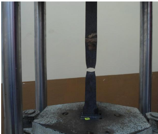
Rotura de probetas
