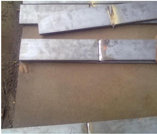
Soldadura de probetas.
