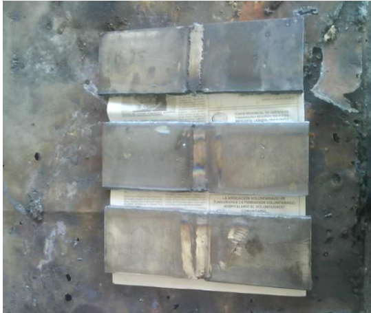
Soldadura de probetas.
