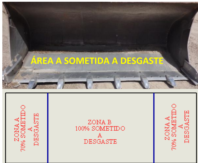
Figura 5.2 Parte inferior interna del cucharón (Zonificación).
