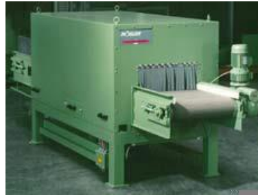
Figura. 2.6: Secador de Cinta Transportadora. (Fuente: ROSLER. Secadores Industriales)
