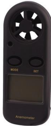
Figura 3.4: Anemómetro portátil. (Fuente: Egdo. Juan Carlos Espinoza F.)
