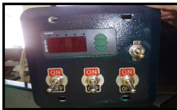
Figura 6.15: Botoneras de accionamiento del secador (Fuente: Egdo. Juan Carlos Espinoza)
