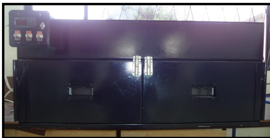
Figura 6.8: Prototipo de secador estático de bandeja por radiación infrarroja
