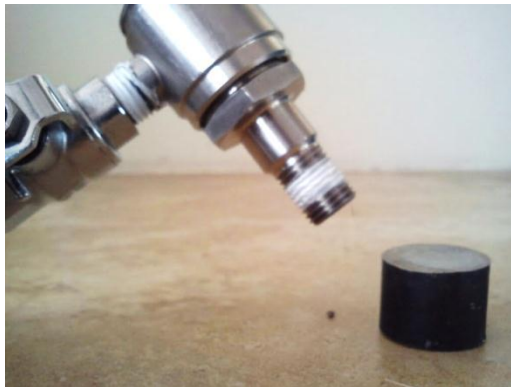
Figura 6-12. Enfriamiento de probeta cilíndrica en corriente de aire a -30 °C generada con el tubo vórtex.
