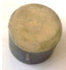
Figura 6-10. Barra cilíndrica de acero 1045 de 2,5 centímetros de espesor y 2 centímetros de longitud.
