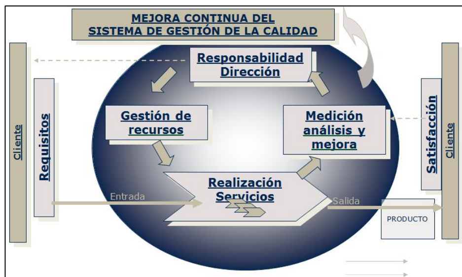
Ilustración 4. Modelo basado en procesos para un sistema de gestión de la calidad.
