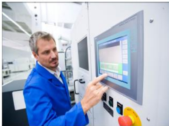
Figura 6.9 Operador utilizando pantalla táctil MP 277
