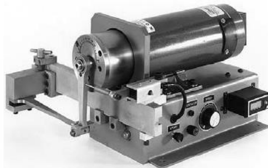
Figura. 6.1 Máquina para ensayos de flexión plana modelo BSS-40H
