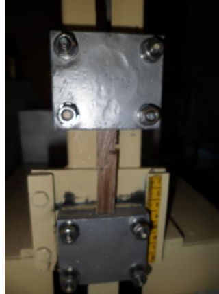
Figura.5.2 Falla de probeta con fibra de cabuya
