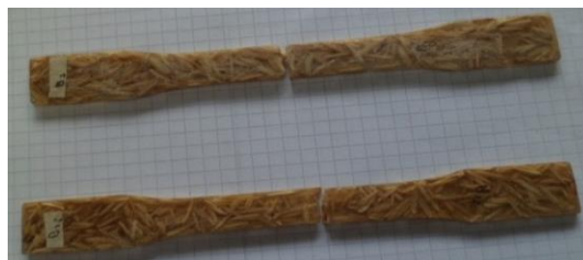
Figura.5.5 Falla de probeta con Cascarilla de arroz Fuente: La Autora
