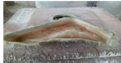
Figura.4.16 Elaboración de un accesorio para carrocería con fibra de cabuya
