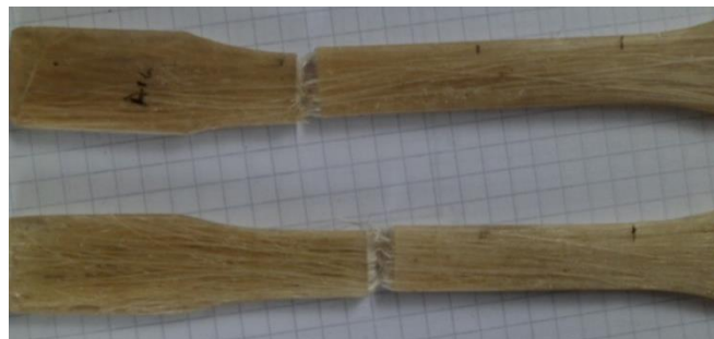
Figura.5.3 Falla de probeta con fibra de cabuya
