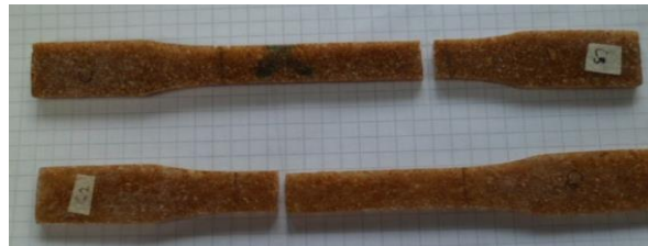
Figura.5.4 Falla de probeta con Aserrín Fuente: La Autora
