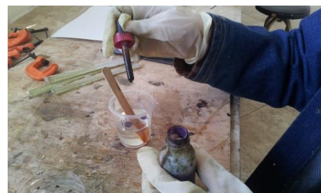
Figura.4.6 Preparación de resina poliéster
