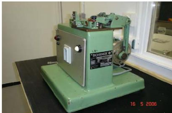
Figura 2.12 Máquina de ensayo a fatiga
