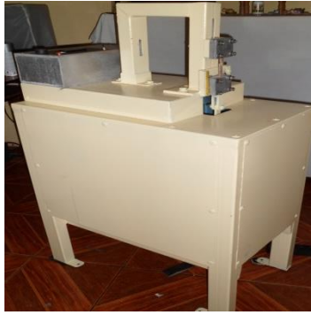
Figura.6.36 Máquina de ensayo a fatiga por tracción Fuente la Autora
