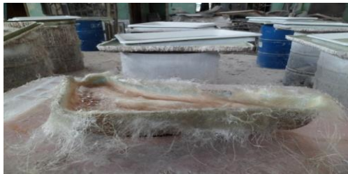
Figura.4.16 Elaboración de un accesorio para carrocería con fibra de cabuya
