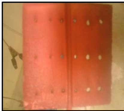
Gráfico N° 56: Placa (PCB) que en el interior de sus agujeros no contiene cobre.
