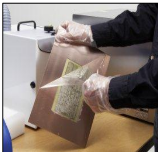
Gráfico N° 14: Extracción de la película. Fuente: http://www.lpkf.es/servicios/index.htm
