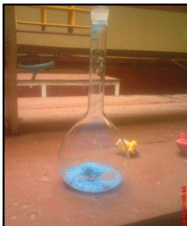
Gráfico N°42: Sulfato de cobre vertido en un balón volumétrico.
