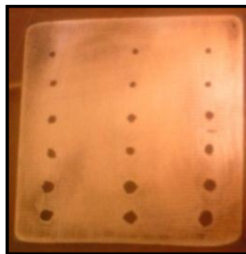
Gráfico N° 38: Placa electrónica después de haber retirado el exceso de tinta conductiva.
