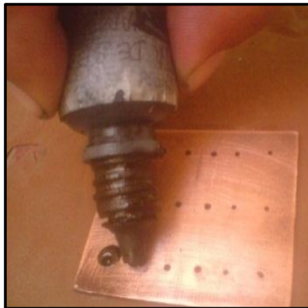
Gráfico N° 36: Colocar la tinta conductiva en cada agujero de la probeta.
