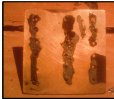
Gráfico N° 37: Placa electrónica que contiene tinta conductiva en los agujeros.
