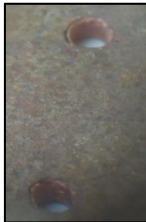
Gráfico N°80: Agujeros de la probeta (PCB) impregnados de cobre en su interior.
