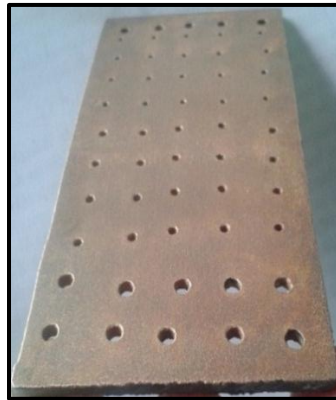
Gráfico N°86: Probeta (PCB) que en el interior de sus agujeros presenta cobre.
