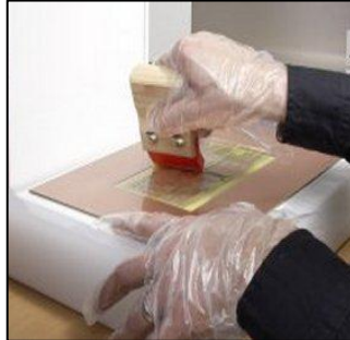
Gráfico N° 12: Uso de la escobilla de goma para aplicar el conductor. Fuente: http://www.lpkf.es/servicios/index.htm
