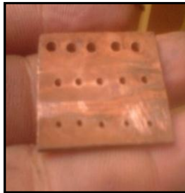
Gráfico N° 67: Probeta (PCB) que después de haber limpiado cuenta con cobre en el interior de sus agujeros.
