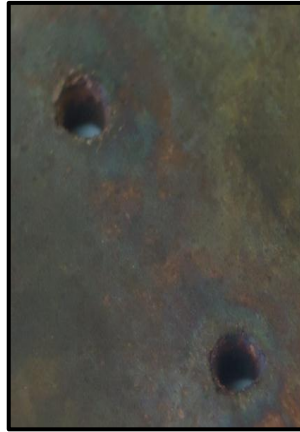
Gráfico N° 70: Hoyos de la probeta (PCB) con cobre adherido en su interior.
