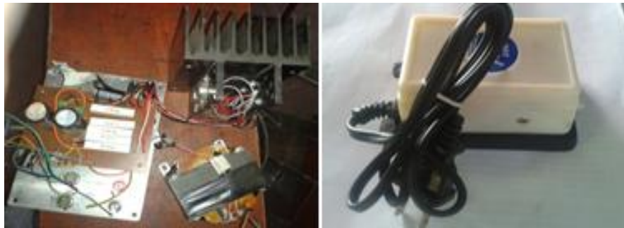
Gráfico N°108: Fuente de corriente cc y bomba de aire de pecera para airear la solución electrolítica.
