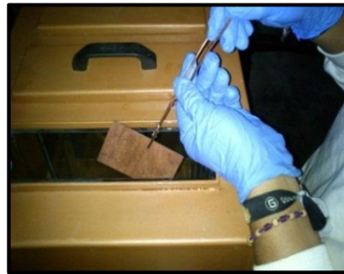
Gráfico N° 46: Sumergir la probeta en la cuba de agua. Elaborado por: El Autor.
