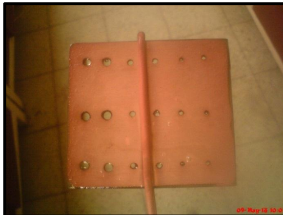
Gráfico N° 69: Placa (PCB) con cobre impregnado en los agujeros.
