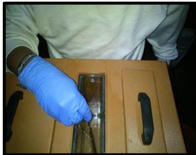
Gráfico N° 47: Sumergir la probeta en la cuba con ácido sulfúrico al 10%. Elaborado por: El Autor.
