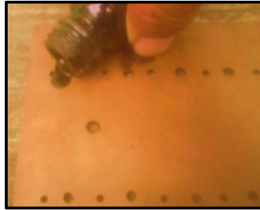
Gráfico N°33: Colocar la tinta conductiva en el interior de los agujeros del PCB.
