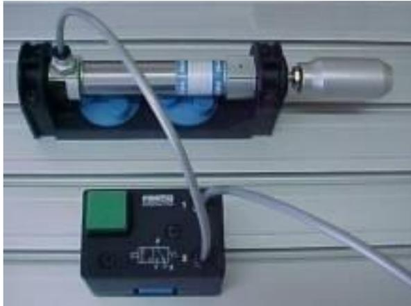
**Figura 2.3: Válvula 2/2 conectada a un cilindro por medio de tubos**
