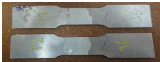
Figura 6.18 Verificación de medidas en Probetas para ensayo de tracción (Fuente: Autor)
