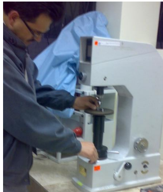
Figura 6.28 Aplicación de carga en el durómetro
