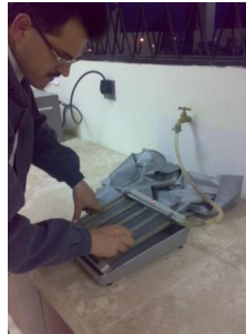
Figura 6.26 Pulido de la Probeta para ensayo de Dureza
