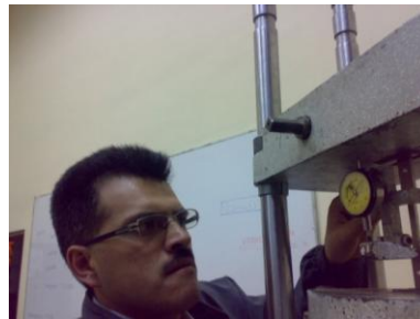
Figura 6.20 Instalación de probeta y deformímetro
