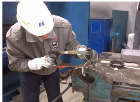
Figura 6.25 Corte de probetas soldadas de aluminio 5086 H-116.
