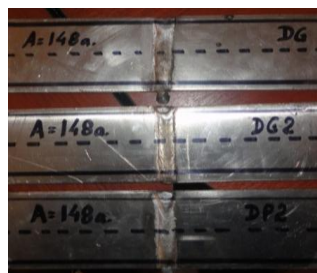
Figura 6.15 Marcado e inspección de probetas soldadas de aluminio 5086 H-116.
