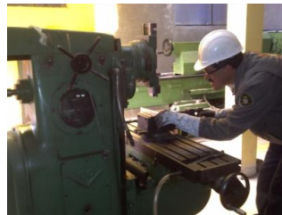
Figura 6.33 Rectificado de superficie para ensayo Metalográfico (Fuente: Autor)
