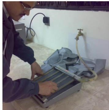
Figura 6.35 Desbaste fino para ensayo Metalográfico
