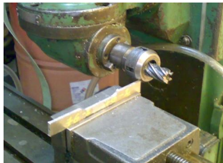
Figura 6.17 Maquinado de Probetas para ensayo de tracción
