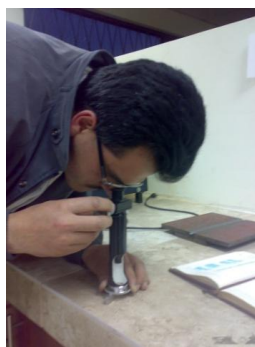
Figura 6.29 Medición de huellas dejadas por el durómetro
