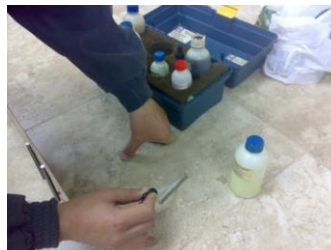
Figura 6.38 Ataque químico de probetas soldadas de aluminio 5086 H-116
