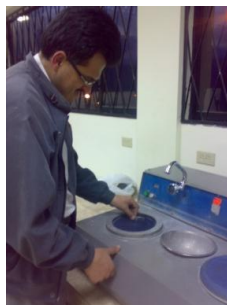
Figura 6.36 Pulido de probetas para ensayo Metalográfico
