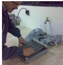
Figura 6.34 Desbaste grueso para ensayo Metalográfico (Fuente: Autor)
