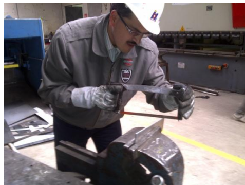
Figura 6.32 Corte de probetas para ensayo Metalográfico.
