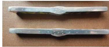
Figura 6.30 Huellas para determinar la dureza.
