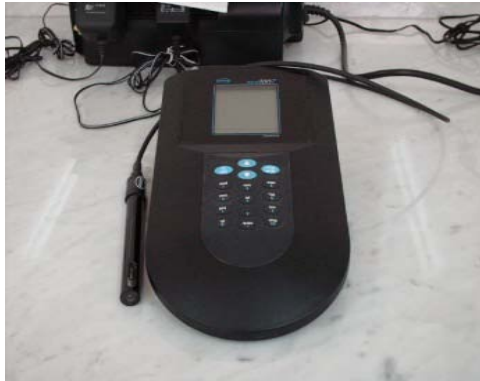
Fotografía F-22 Equipo para medir DQO
