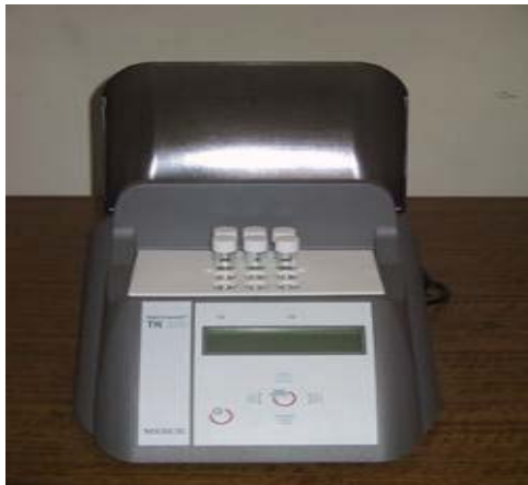
Fotografía F-22 Equipo para medir DQO
