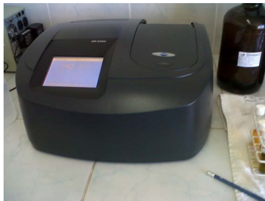
Fotografía F-24 Espectrofotómetro
