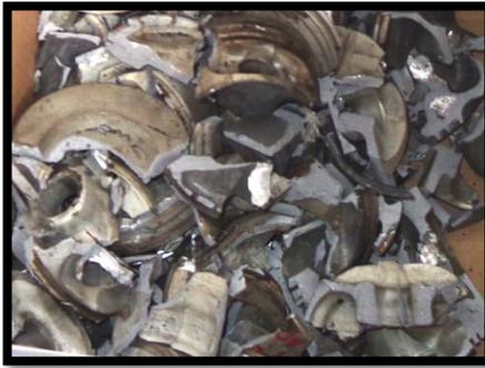
**Figura 6.6** Pistones rotos por la prensa.
