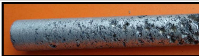
**Figura 4.4** Probeta con presencia de macroporos obtenida de la prueba 8 .
