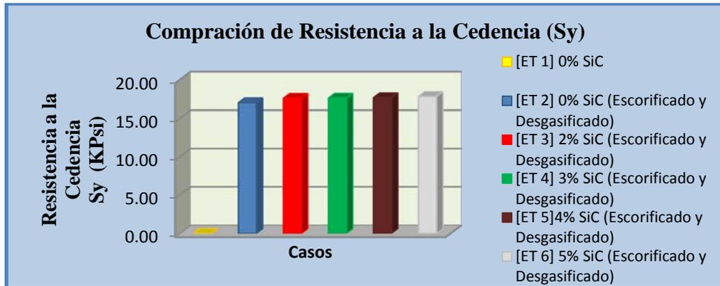
**Figura 4.8** Comparación de Resistencia a la Cedencia (Sy).
