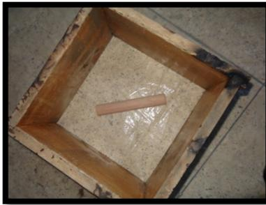
**Figura 6.14** Caja inferior invertida con la mitad del modelo cilíndrico boca abajo.
