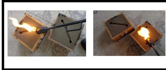
**Figura 6.20** Secado de la arena de moldeo con mechero a gas.
