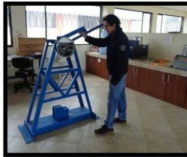
**Figura 6.52** Probeta colocada en los apoyos del péndulo Charpy.
