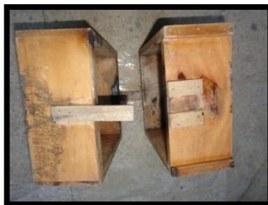
**Figura 6.9** Caja de moldeo. (A la izquierda se encuentra la parte con guías macho y a la derecha con guías hebra)
