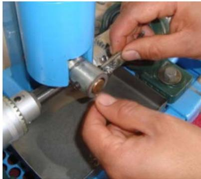
**Figura 6.56** Sujeción de la probeta fija.
