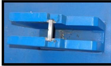
**Figura 6.51** Probeta colocada en los apoyos del péndulo Charpy.
