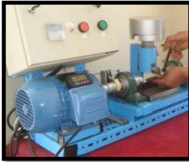
**Figura 6.57** Sujeción de la probeta móvil.
