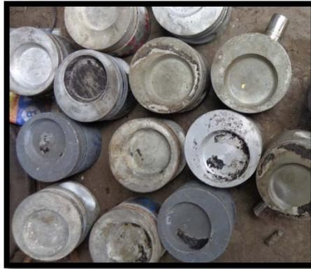
**Figura 6.2** Pistones 4032 reciclados en rectificadoras y mecánicas.
