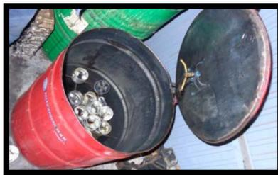
**Figura 6.3** Prelavado de Pistones – Baño en solución química
