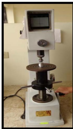
**Figura 2.12** Máquina de ensayos de dureza. (Durómetro)
