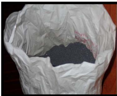
**Figura 3.** Carburo en polvo malla #400 (37  $\mu\text{m}$ ).
