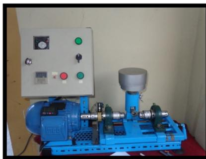
**Figura 6.55** Tribómetro de Desgaste Adhesivo en seco.
