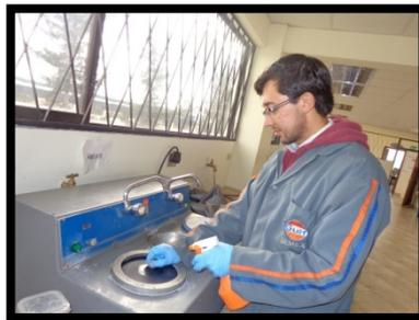
**Figura 6.41** Pulido de la probeta en Pulidora de Disco.
