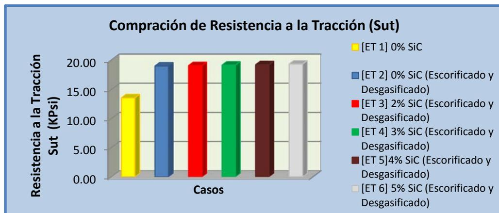
**Figura 4.7** Comparación de Resistencia a Tracción (Sut).
