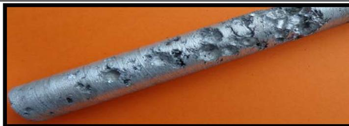
**Figura 4.6** Probeta con presencia de macroporos obtenida de la prueba 9.
