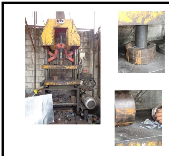
**Figura 6.5** Prensa Hidráulica utilizada para la rotura de los pistones.
