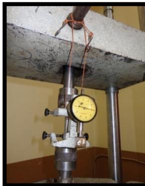
**Figura 6.36** Asegurado con pasador del deformímetro.
