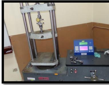
**Figura 6.37** Máquina Universal lista para en ensayo.
