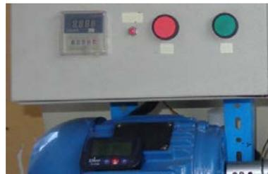
**Figura 6.59** Cronómetro y contador de revoluciones.
