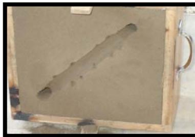
**Figura 6.19** Forma del modelo en la arena con los canales de distribución.
