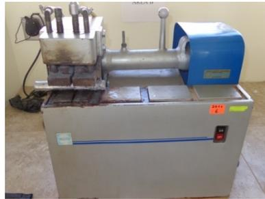
**Figura 6.39** Corte de la probeta en Discotom para Análisis Metalográfico.
