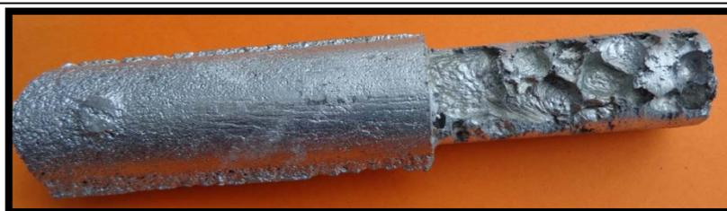
**Figura 4.3** Probeta con presencia de macroporos obtenida de la prueba 7.
