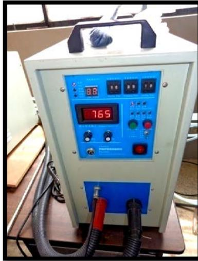
**Figura 6.21** Panel de control del Horno de inducción.
