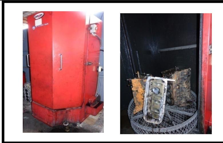
**Figura 6.4** Lavado a presión con agua caliente.
