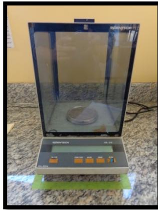
**Figura 6.54** Balanza F.I.C.A.L de 0.1 mg de precisión.
