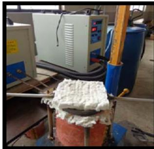
**Figura 6.22** Crisol de Grafito Aislado con Lana Térmica.
