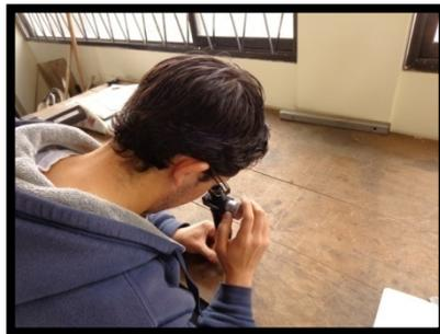
**Figura 6.49** Medición de la huella en la probeta.
