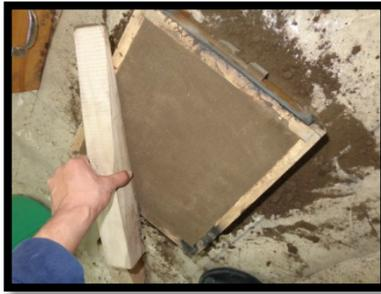
**Figura 6.15** Nivelado de la caja de moldeo con un perfil plano.
