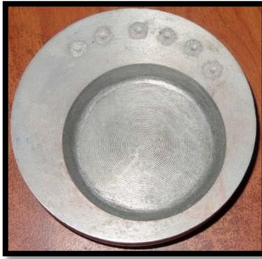
**Figura 2.** Cabeza de Pistón de Chevrolet Luv 2.2i. Analizada químicamente por FALESA.
