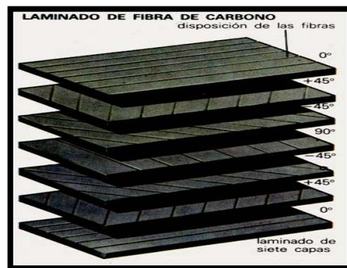
**Figura 2.5 Laminado de fibras de carbono.**
