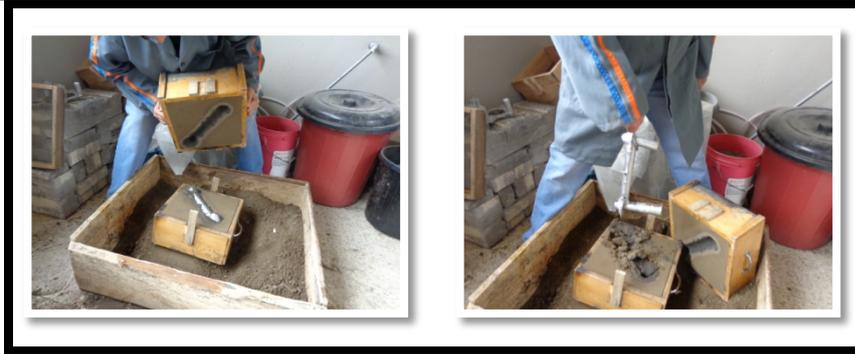
**Figura 6.29** Desmolde de probetas del molde de Arena.
