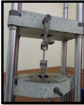
**Figura 6.34** Probeta montada en la máquina Universal.
