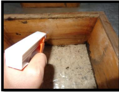
**Figura 6.13** Paredes de las cajas de moldeo humedecidas con un chisguete.
