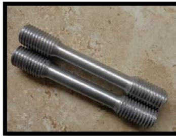
**Figura 6.33** Probetas para el ensayo a tracción bajo la norma ASTM E8:00b
