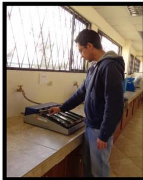
**Figura 6.40** Desbastado de la probeta en el Banco de Lijas.
