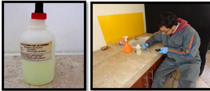
**Figura 6.43** Ataque químico. Reactivo de keller (5 ml de  $\text{HNO}_3$  y 190 ml de agua destilada)
