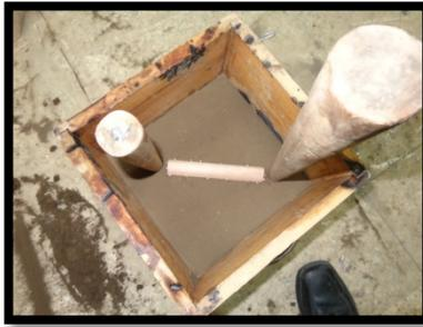
**Figura 6.17** Ensamble del par superior de la caja de moldeo y ubicado de los bebederos.
