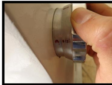
**Figura 6.46** Selección de la carga del durómetro.
