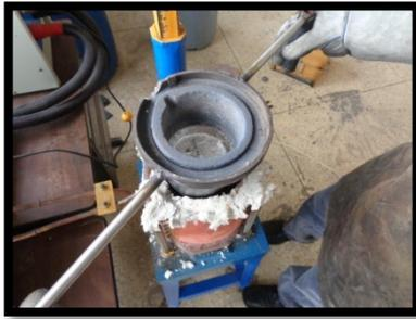
**Figura 6.27** Colada de Aleación de Aluminio 4032 Homogenizada con Carburo de Silicio SiC.
