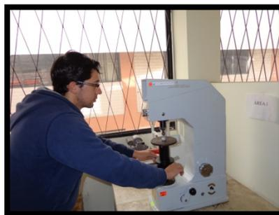
**Figura 6.47** Encerado del indentador contra la probeta.
