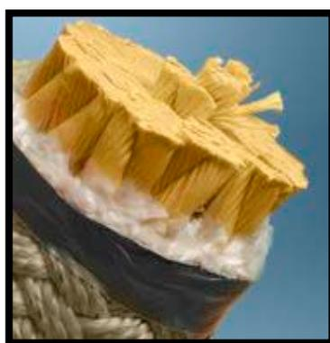
**Figura 2.4** Fibra de arámida para refuerzo de cordaje y cable.
