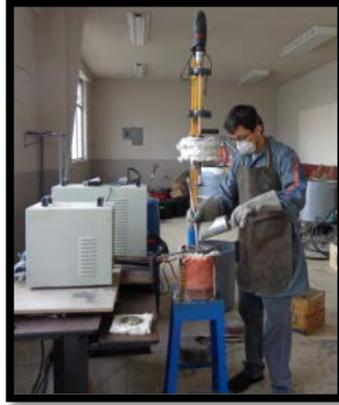
**Figura 6.23** Adición del escorificador a la colada.
