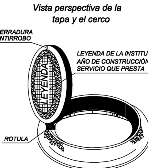
TAPA Y CERCO PARA POZOS DE REVISIÓN Escala 1:20
