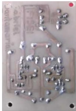
Figura 6.18 Circuito impreso diseñado de forma manual. Autor: El investigador
