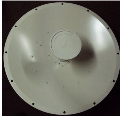
Figura 6.32: Antena para enlace PTP Ubiquiti Rocket Dish.
