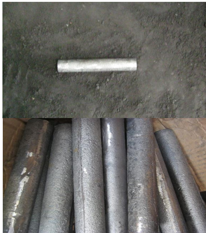
Gráfico 6.7.4.1 Ejes de hierro nodular salido del molde
