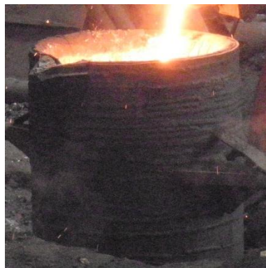
Gráfico 6.7.2.9 Metal fundido listo para verter Fuente: Autor
