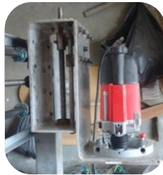
Fig. 6-27. Carros deslizantes ejes "Y" y "Z", en conjunto
