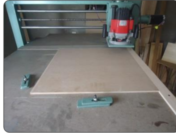
Fig. 6-23. Fijación del tablero a moldurarse utilizando el Router CNC.
