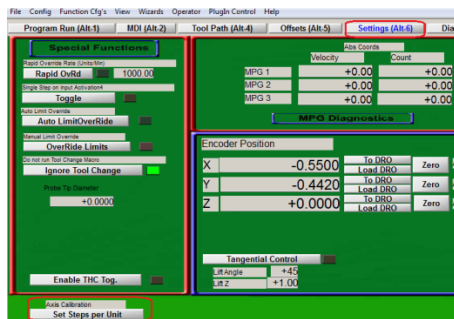
Fig. 6-44. Configuración automática de pasos por unidad
