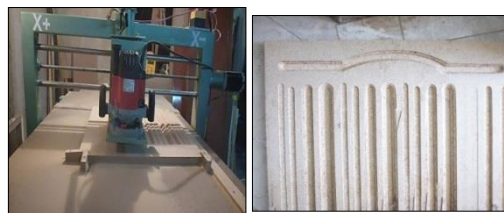
Fig. 6-61 Prueba realizada en tablero MDP.
