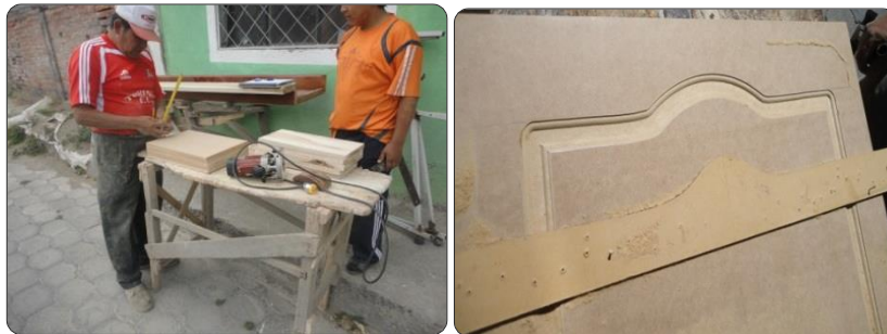
Fig. 6-24. Estabilización del tablero sobre una mesa sin sistema de fijación y plantilla utilizada.
