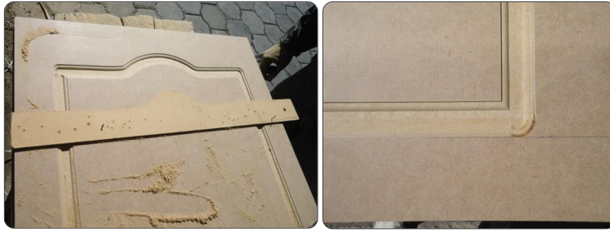
Fig. 4-1. Utilización de plantillas en el moldurado y quemadura del perfil.
