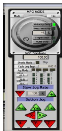
Fig. 6-50. Control flotante de deslizamiento de los ejes "X", "Y", "Z"
