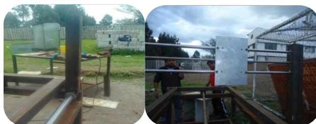
Fig. 6-26. Construcción del puente deslizante del Router CNC
