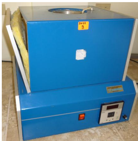
Figura 4-6 Horno de Tratamientos Térmicos y Enfriamiento en Sales Fundidas Fuente: Laboratorio de Materiales
