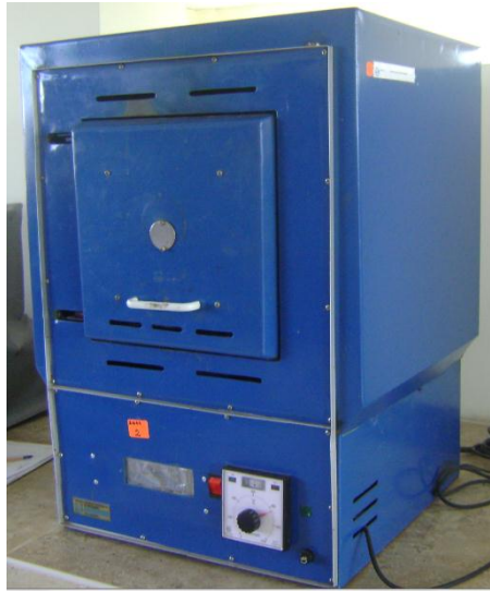
Figura 4-5 Horno de Tratamientos Térmicos Fuente: Laboratorio de Materiales
