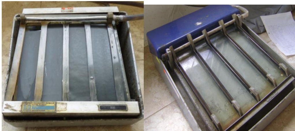
Figura 4-10 Banco de devaste para cuatro tipos de papel abrasivo. Fuente: Laboratorio de Materiales
