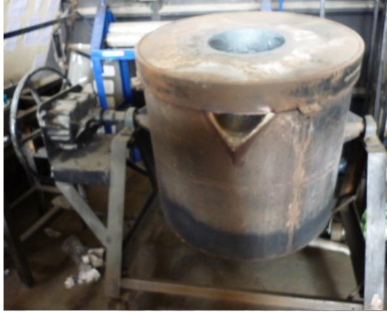
Figura 4-15 Horno Giratorio para Fundir Aluminio y Bronce. Fuente: Taller de Soldadura.
