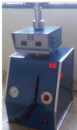
Figura 4-8 Prensa Hidráulica Manual para Montaje de Probetas Fuente: Laboratorio de Materiales
