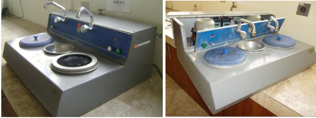
Figura 4-11 Banco de pulido de dos puestos.
