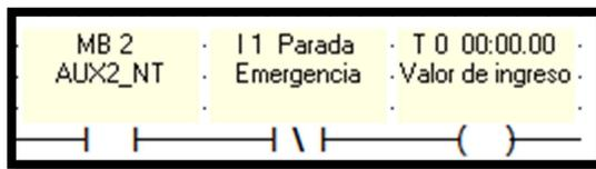
Figura N° 55. Conexiones para la habilitación del temporizador.
