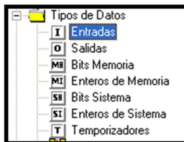
Figura N° 28. Tipos de datos del U90 Ladder.
