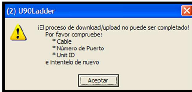
Figura N° 79. Mensaje de error de conexión entre PLC y PC.
