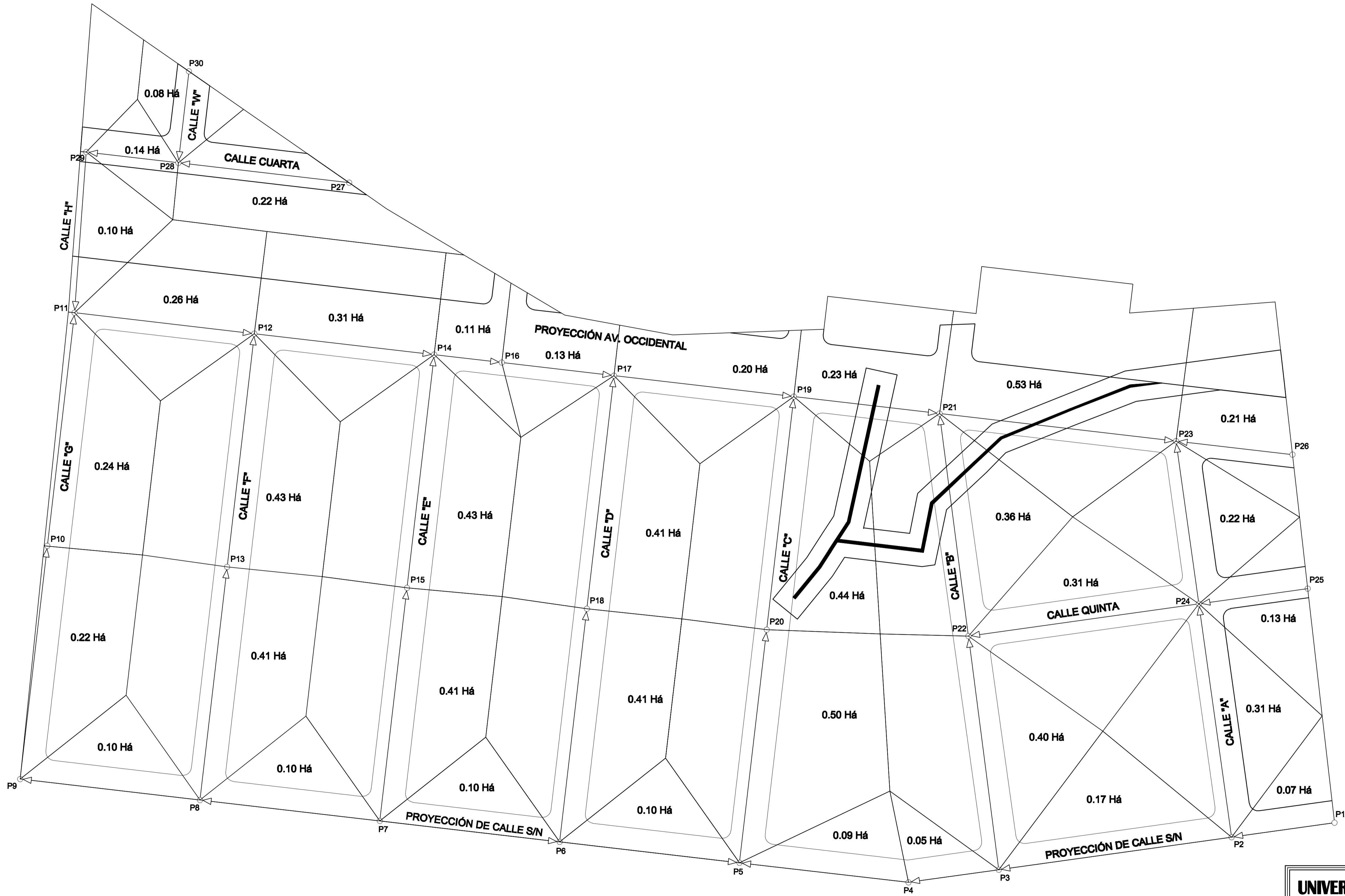
ÁREAS DE APORTACIÓN DEL ALCANTARILLADO SANITARIO ESCALA 1:760
