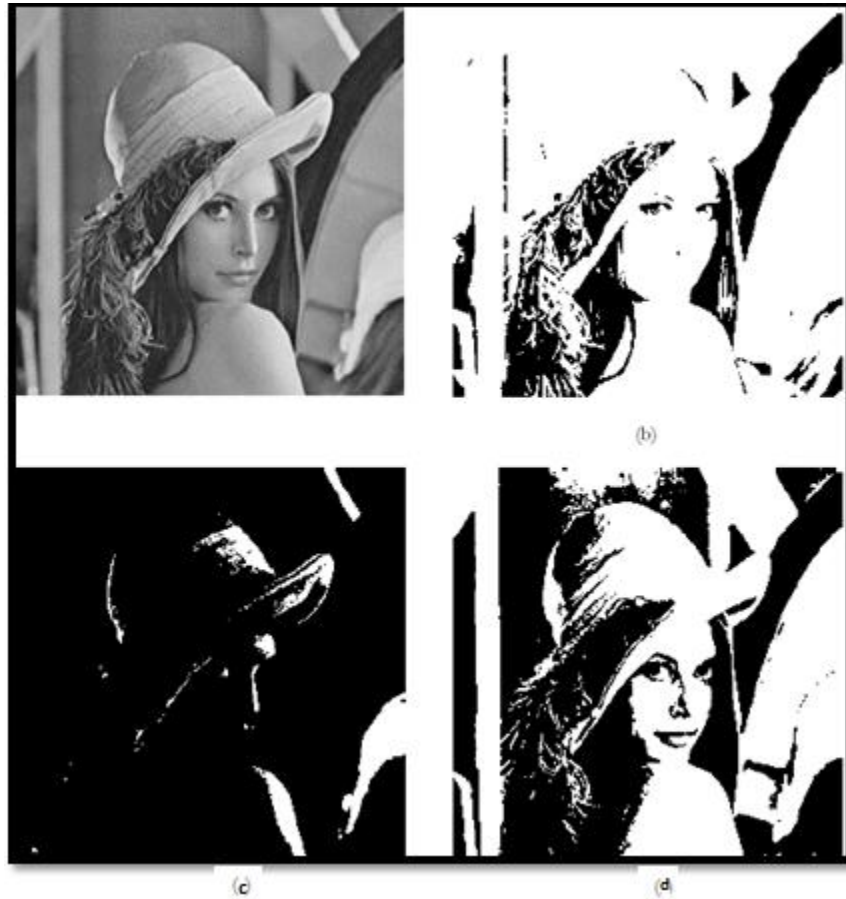
Fig 2.31.- Lenna a 256 niveles de gris b) lenna con un umbral bajo; c) con umbral alto; d) con umbral intermedio
