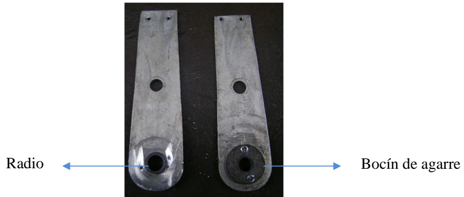
Figura 82.- Laterales-2 con sus respectivos bocines
