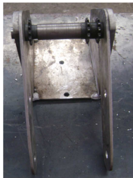
Figura 81.- Hombro más laterales-1 ensamblados
