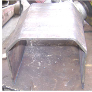
Figura 89.- Plancha de acero doblada con la forma de la base
