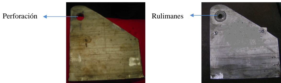
Figura 70.- Hombro del brazo robótico
