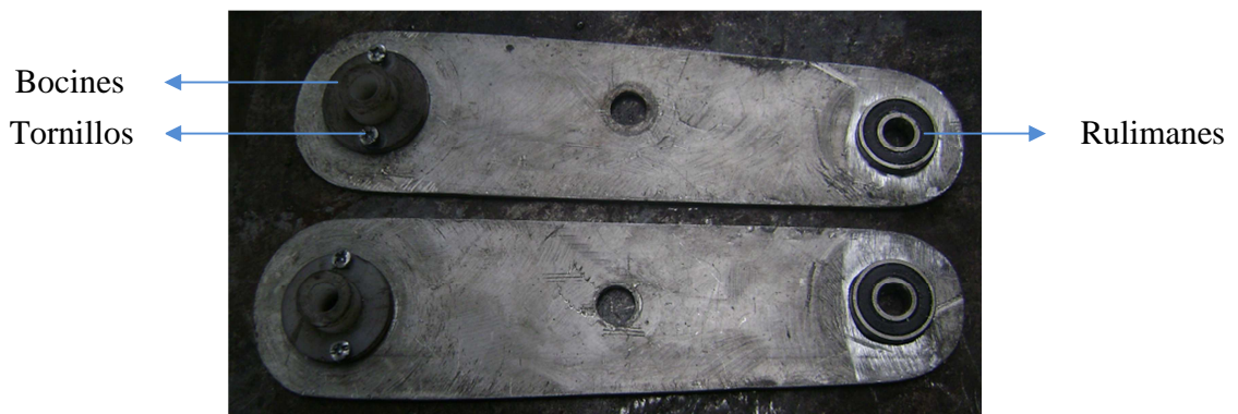
Figura 74.- Laterales-2 con bocines y rulimanes
