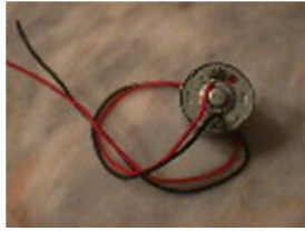
Figura 33.- Suelda de cables al motor del Servo.
