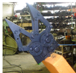
Figura 138.- Giro a la derecha de la muñeca (Max= una vuelta)
