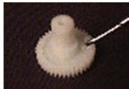
Figura 35.- Piñón sin limitación mecánica para el giro completo.
