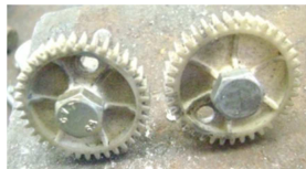
Figura 95.- Piñones conducidos de la pinza
