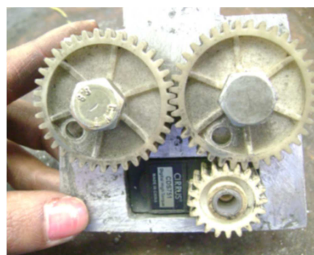
Figura 96.- Ubicación de los piñones de la pinza
