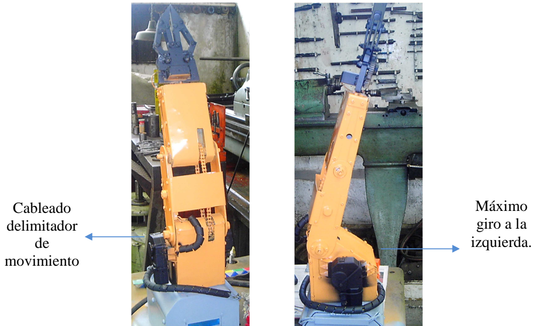
Figura 137.- Giro a la izquierda (Max= una vuelta y media)
