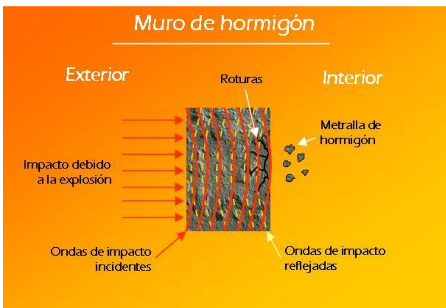
Gráfico # 35: Muro de protección sin aglutinante
