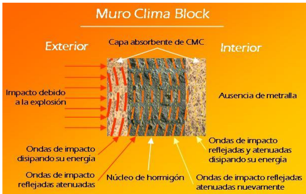
Gráfico # 36: Muro de protección con aglutinante
