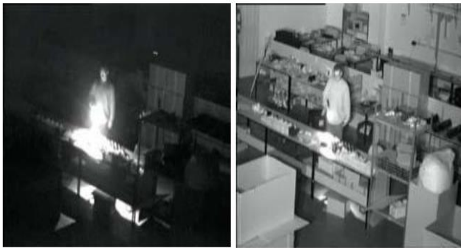
Figura 17: Comparación de imágenes con infrarrojo y sin infrarrojo. [38]
