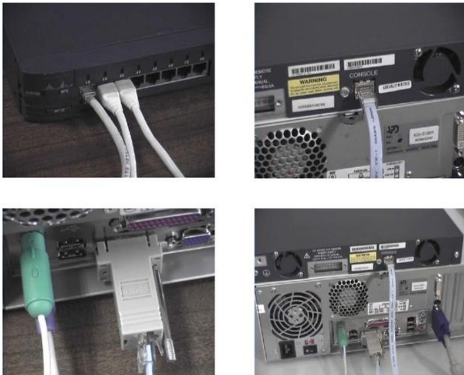
Figura 55: Conexión física del switch y las computadoras
