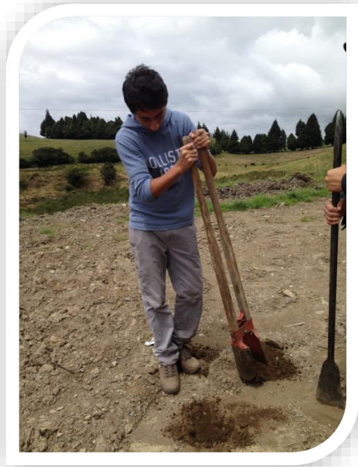
Extracción de muestras de suelo.
