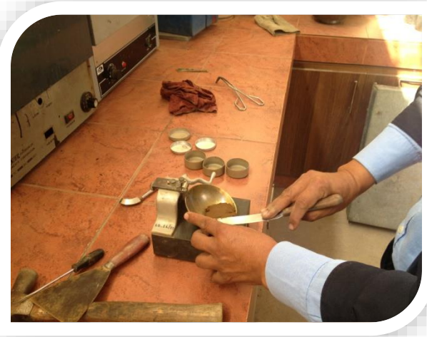
Estudios de suelo - Ensayo de plasticidad.
