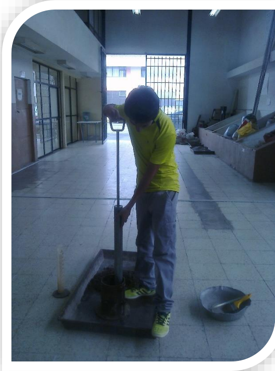
Compactación y CBR
