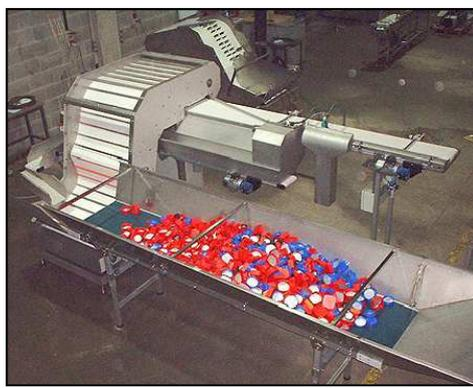
**Figura. 2.5:** Orientador de tapas con cinta pulmón.
