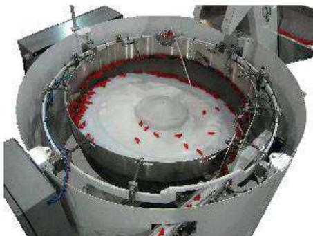
**Figura. 2.4:** Orientador de Tapas Centrífugo
