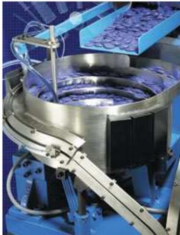
**Figura. 4.1:** Orientador vibratorio de Tapas
