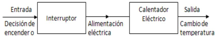
**Figura. 2.22:** Ejemplo de un sistema de control de lazo abierto
