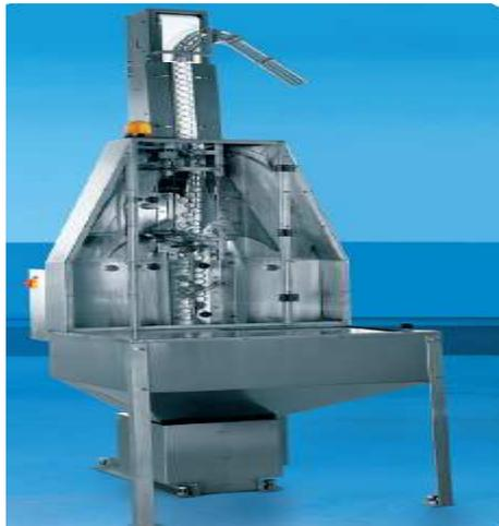
**Figura. 2.7:** Alimentadores de tapas con elevador magnéticos
