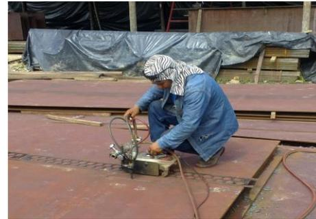
Dimensionamiento de cada una de las planchas de Acero ASTM A588
