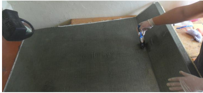
Gráfico 6.28. Estratificación manual de resina epóxica
