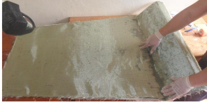
Gráfico 6.30. Colocación de 8 capas de tejido carbono/kevlar
