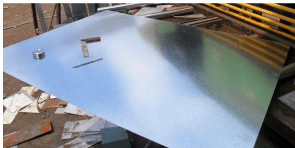
Gráfico 6.1. Trazado de medidas en lámina de tol
