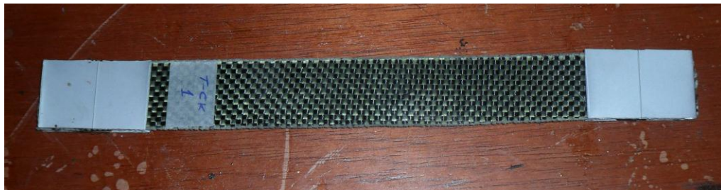
Gráfico 4.15. Probeta de fibra de carbono/kevlar preparada para ensayar a tracción
