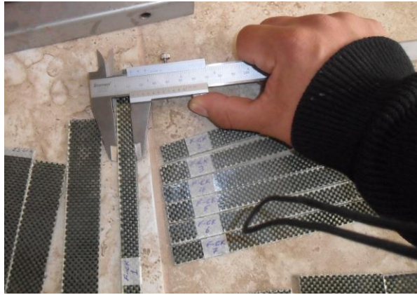
Gráfico 4.13. Medición de probetas
