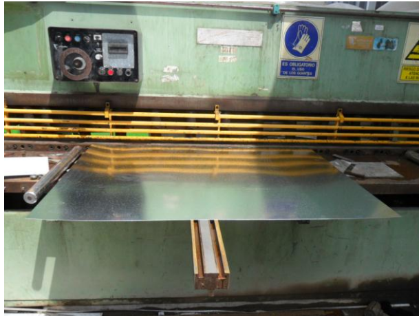
Gráfico 6.2. Corte de la lámina de acero galvanizado
