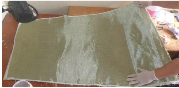
Gráfico 6.26. Colocación de capas de tejido carbono/kevlar
