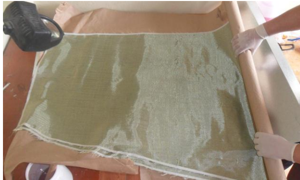
Gráfico 6.25. Selección y configuración de capas de tejido carbono/kevlar
