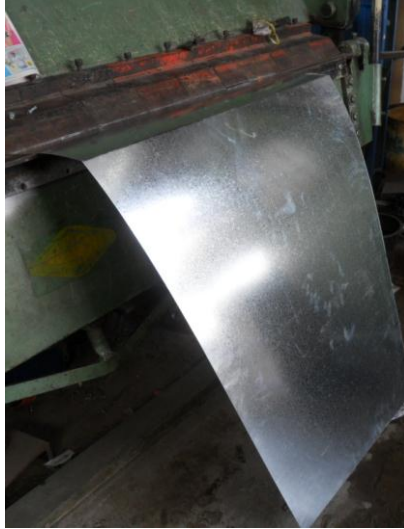
Gráfico 6.4. Doblado de lámina de acero galvanizado
