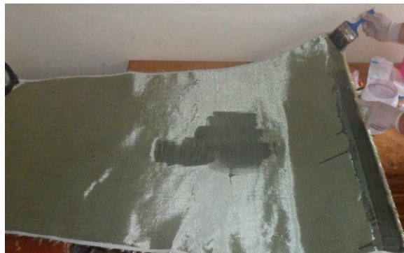
Gráfico 6.27. Estratificación manual de resina epóxica
