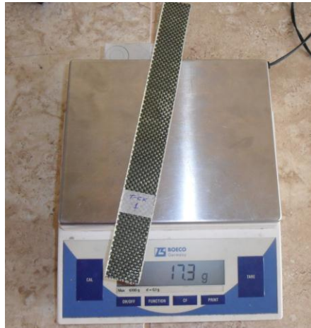
Gráfico 4.14. Pesaje de probetas
