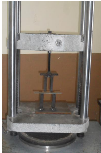
Gráfico 4.20. Desarrollo del ensayo a flexión.
