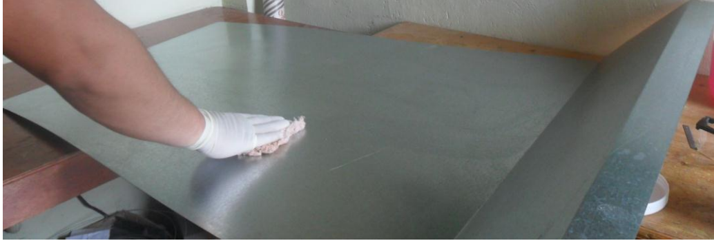
Gráfico 6.23. Aplicación de sustancias desmoldantes
