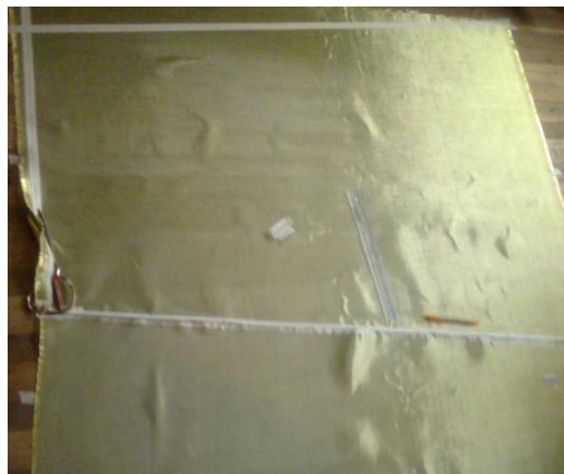
Gráfico 6.22. Delineamiento y corte del tejido mixto carbono/kevlar
