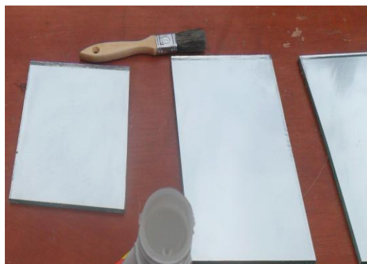
Gráfico 4.7. Aplicación de cera en el molde
