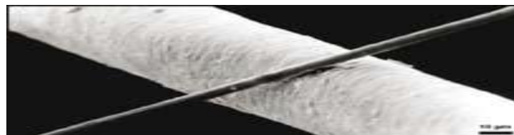
Figura 2.7: Entre 5 y 10 micras mide un filamento de carbono, cinco veces más delgado que un cabello humano.
