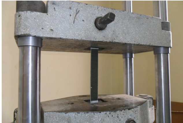
Gráfico 4.16. Probeta de fibra de carbono/kevlar colocada en la Máquina Universal
