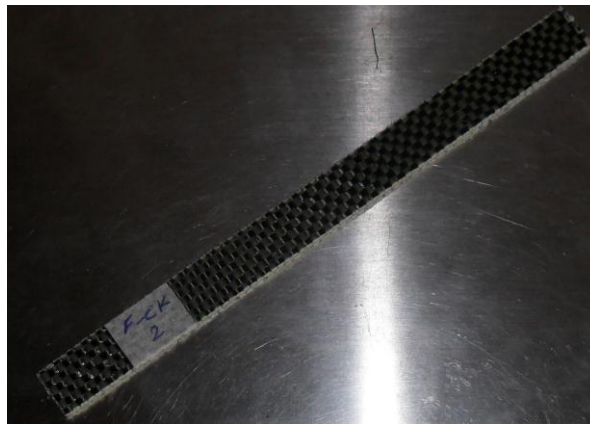
Gráfico 4.18. Probeta de fibra de carbono/kevlar lista para el ensayo a flexión.
