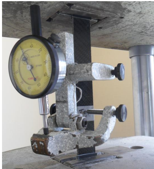
Gráfico 4.17. Medidor de deformación colocado en la Probeta previo al ensayo de tracción
