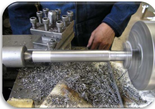
Figura. 6.42 Construcción del eje disco porta paño
