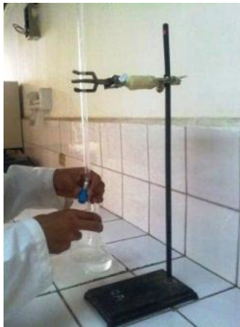
Fotografía D16. Medición de Acidez
