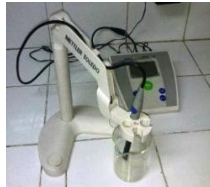
Fotografía D17. Medición de pH
