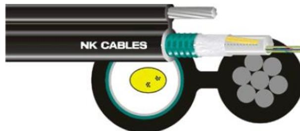
FIGURA No 2.25 Esquema de un cable ADSS
