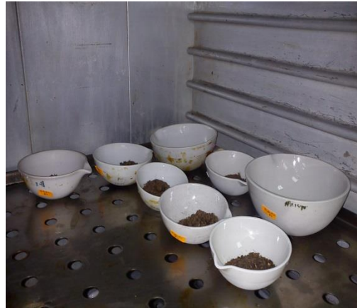
Fotografía C-7.- Control de humedad de los diferentes tratamientos
