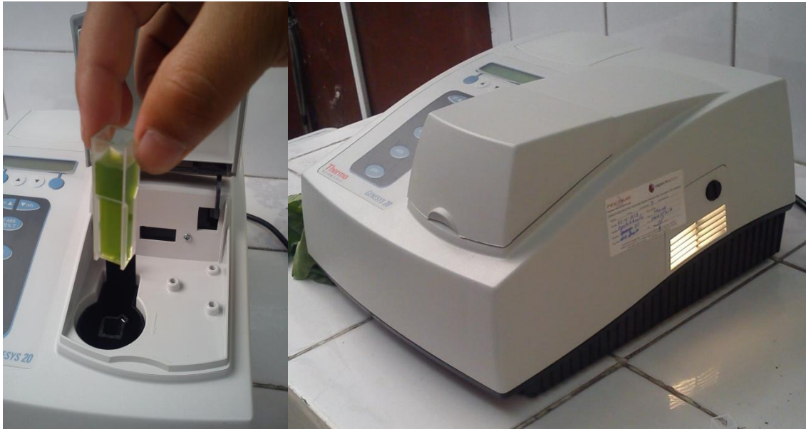
Fotografía C-18.- Medición de absorbancias de los diferentes extractos
