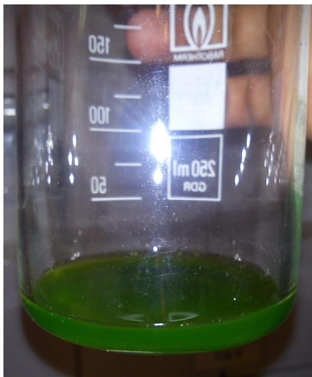
Fotografía C-16.- Maceración de la muestra con acetona
