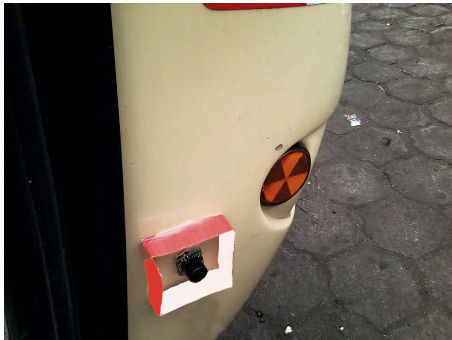
Figura 5. 18 Ubicación de los sensores de la parte frontal
