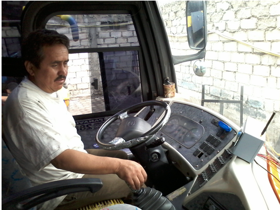
Figura 5. 17 Ubicación sistema electrónico de control de velocidad en el tablero del autobús
