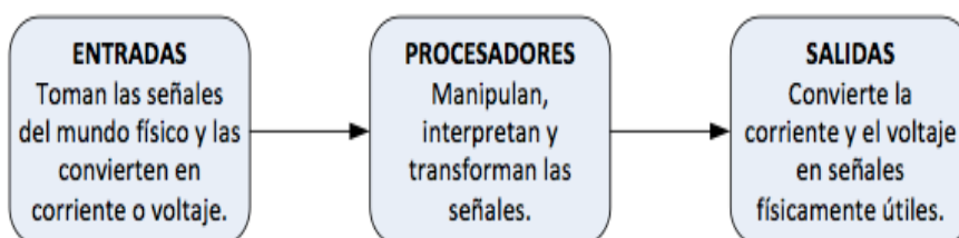
Figura 2. 1 Partes de un Sistema Electrónico
