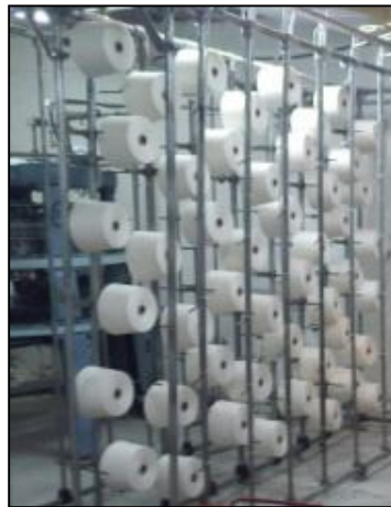
Anexo G.2. Colocación de Hilo en la Fileta Fuente: TEX-MODA
