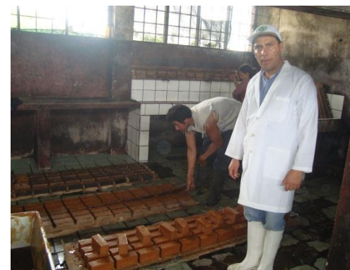
18 Desmoldeo y enfriamiento
