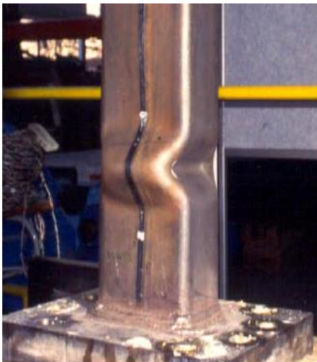
GRÁFICO II.8. Pandeo local en un tubo de acero sometido a compresión
