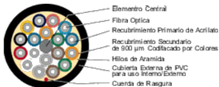
Figura 32: Partes de una Fibra de varios hilos.
