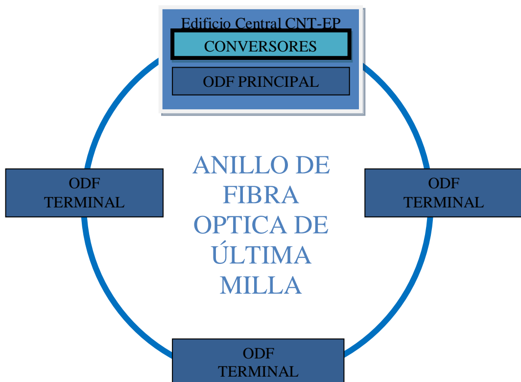
Figura 41: Esquema general del anillo de fibra óptica de ultima milla.
