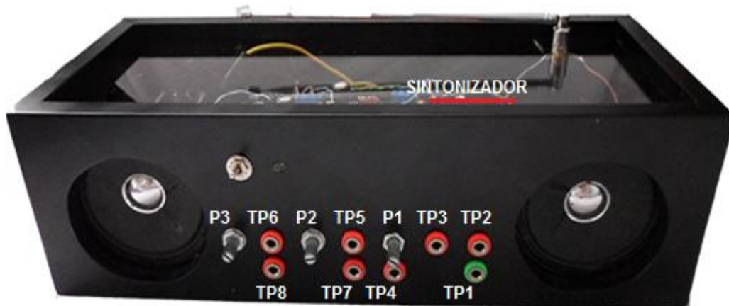
Figura 4. 46: Transmisor FM montado en Chasis
