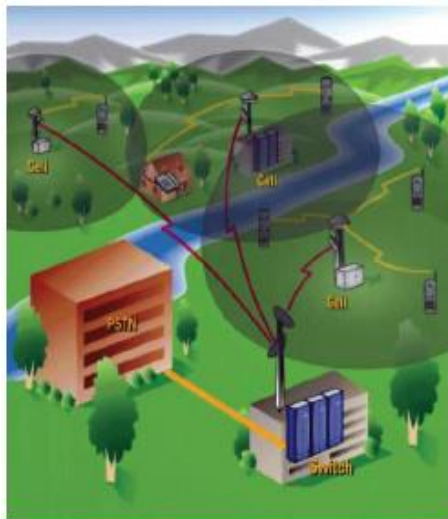
Fig 2.9. Funcionamiento de la red celular
