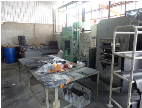
Figura 5: Vulcanizado de moquetas Fuente: Investigador
