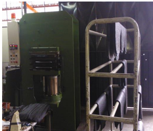
Figura 13: Máquina de vulcanizado Fuente: Investigador
