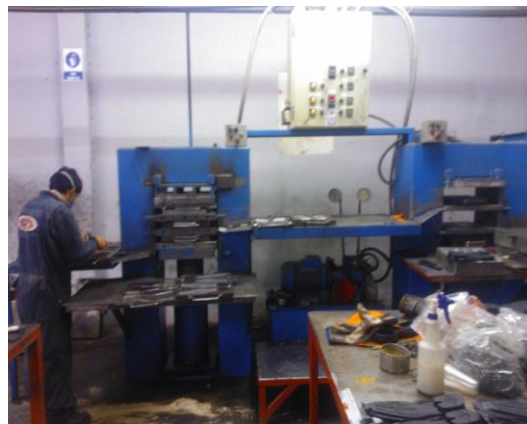
Figura 15: Máquina de vulcanizado de plantas Fuente: Investigador
