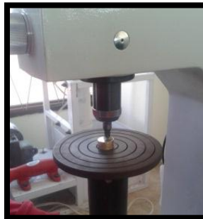
Figura 6-43: Probeta colocada en la base del durómetro.
