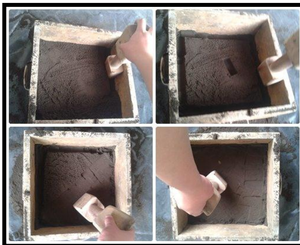
Figura 6-9: Compactación de la arena de moldeo.
