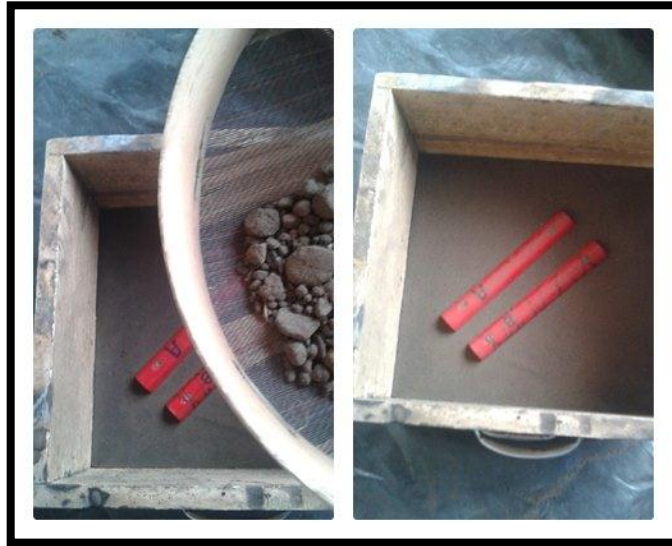
Figura 6-14: Colocación de una fina capa de arena seca.
