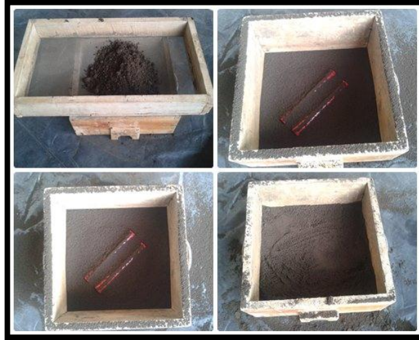
Figura 6-8: Colocación de una capa de arena de moldeo sobre los modelos.
