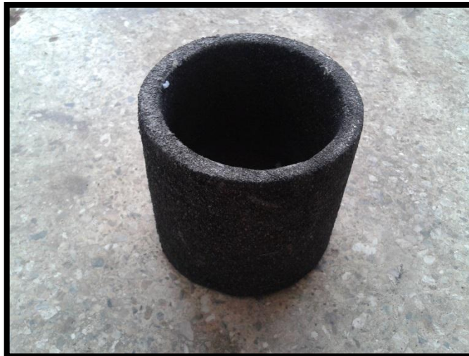
Figura 4-3: Crisol de grafito luego de ser maquinado en un torno.
