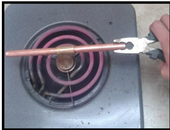
Figura 4-55: Calentamiento del acople.
