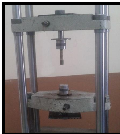
Figura 6-39: Enroscado de los extremos de la probeta a los acoples de la máquina universal.
