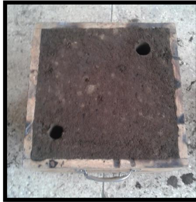
Figura 6-20: Molde de arena terminado.
