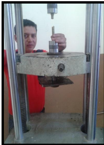
Figura 6-41: Probeta rota luego del ensayo en la máquina universal.
