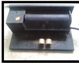
Figura 6-52: Secado de las muestras mediante una corriente de aire.
