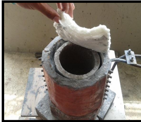
Figura 6-23: Colocación del crisol en la bobina.
