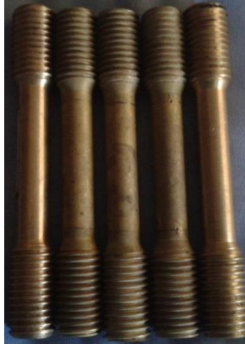
Figura 4-29: Probetas templadas para el ensayo de tracción.
