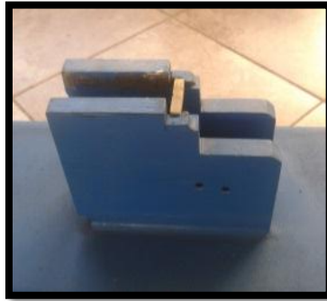
Figura 6-45: Probeta colocada en la base del péndulo charpy.
