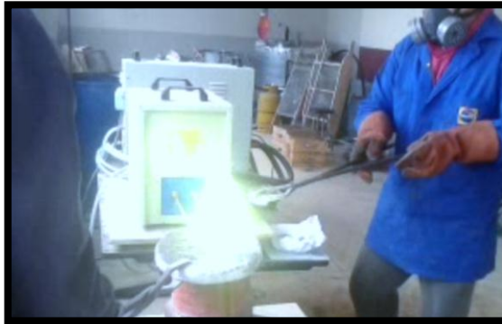
Figura 6-26: Adición de estaño para completar la aleación CuZnSn.
