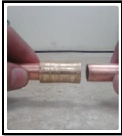
Figura 4-54: Introducción de la tubería en el acople.
