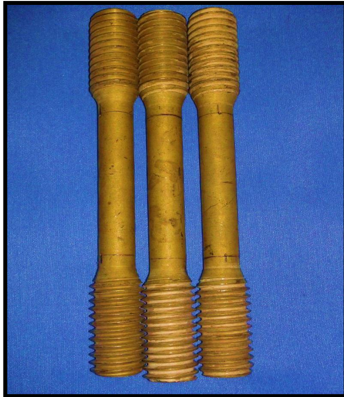
Figura 4-35: Probetas templadas para el ensayo de tracción.
