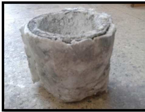
Figura 6-22: Crisol forrado con manta cerámica.
