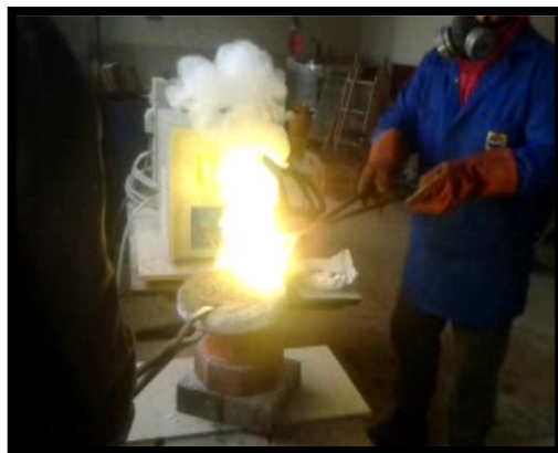
Figura 6-25: Adición de zinc en el cobre previamente fundido.
