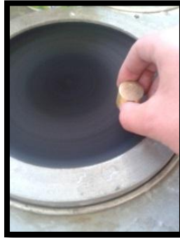
Figura 6-49: Pulido de la muestra en pulidora de paño.
