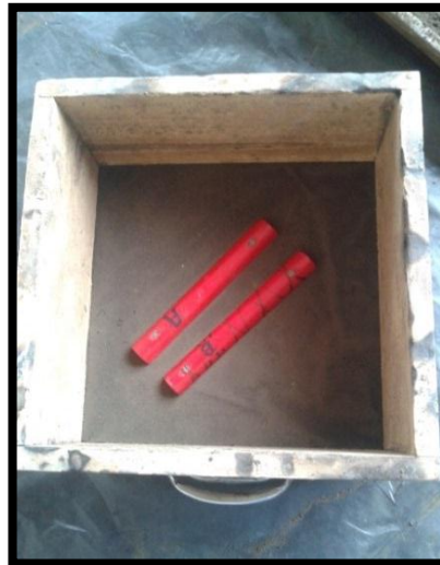
Figura 6-13: Colocación de la caja de moldeo macho.
