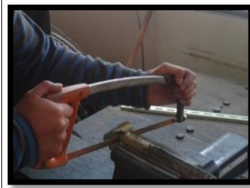
Figura 6-47: Corte de probetas para el análisis metalográfico.
