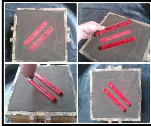
Figura 6-12: Colocación de la segunda parte de los modelos.
