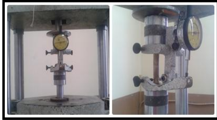
Figura 6-40: Colocación del deformímetro haciendo coincidir las patas del mecanismo con los puntos de calibración de 2 pulgadas.
