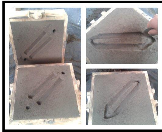
Figura 6-18: Realizando los canales para los bebederos.
