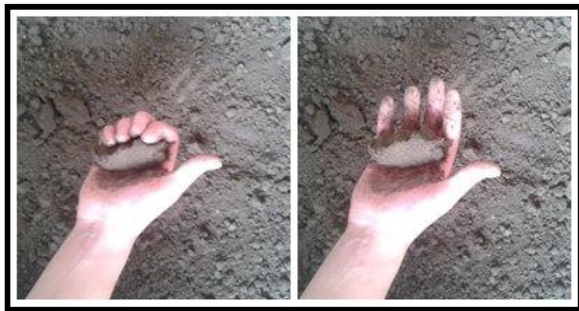
Figura 6-7: Aplicación del método del puño.
