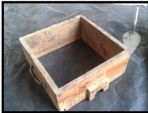
Figura 6-3: Modelos de madera (tipo eje).
