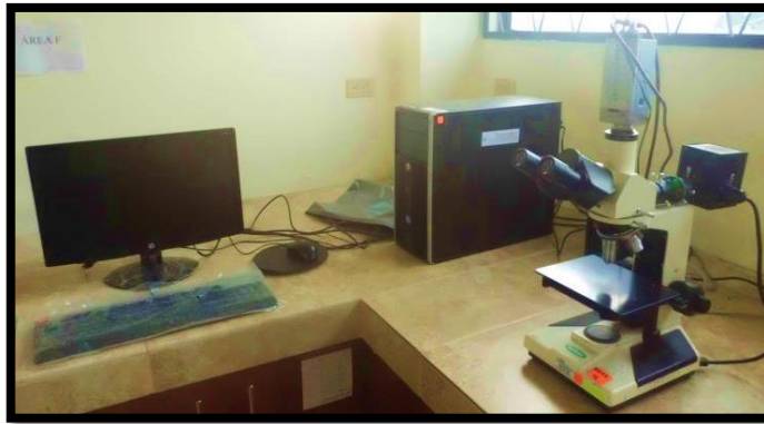
Figura 4-11: Microscopio metalográfico, con proyección al monitor del computador FICM-UTA.
