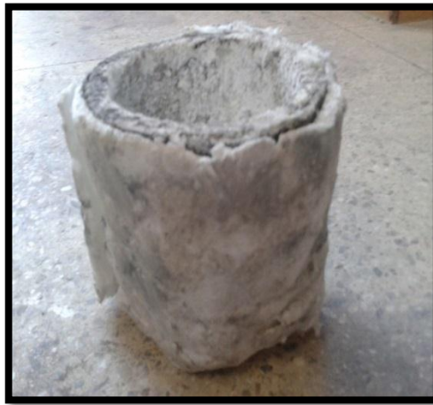
Figura 4-24: Crisol cubierto con manta térmica no combustible.
