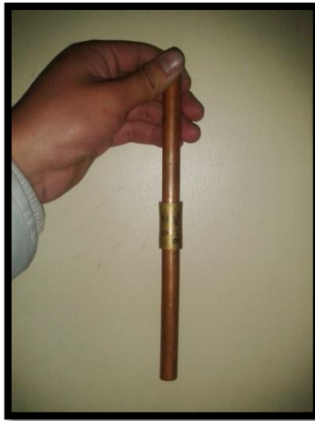
Figura 4-56: Tubería de cobre unida por medio del acople (SMA base cobre).
