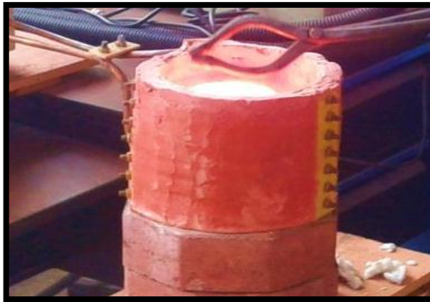
Figura 4-4: Prueba 1, crisol colocado en la bobina del horno de inducción cargado con cobre.
