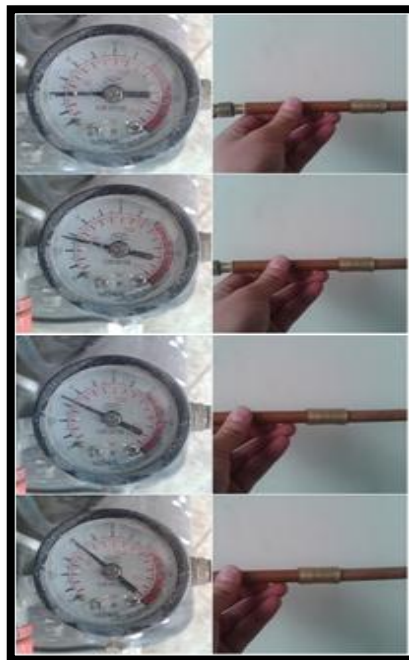
Figura 4-57: Prueba del acople a diferentes presiones
