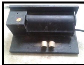
Figura 6-50: Secado de las muestras mediante una corriente de aire.
