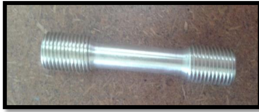
Figura 6-33: Probeta maquinada para el ensayo de tracción.
