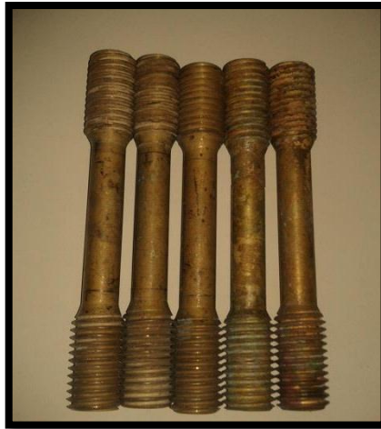
Figura 4-42: Probetas templadas para el ensayo de tracción.
