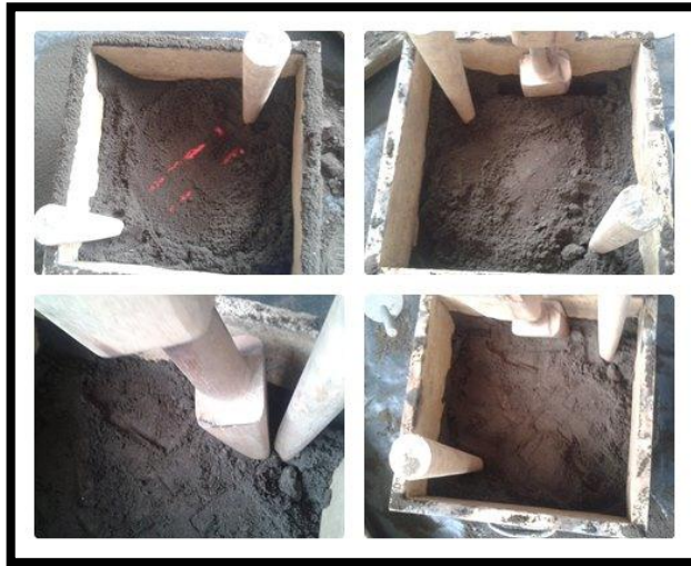
Figura 6-15: Colocación de los bebederos y una capa de arena de moldeo.
