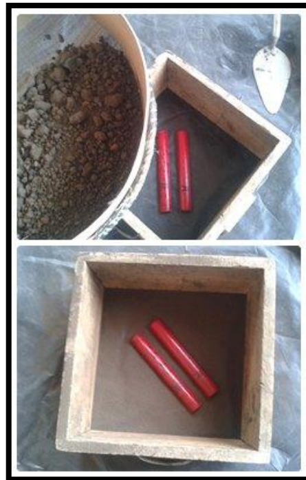
Figura 6-5: Colocación de una capa fina de arena.
