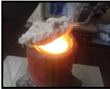
Figura 6-24: Crisol en la bobina con cobre fundido.
