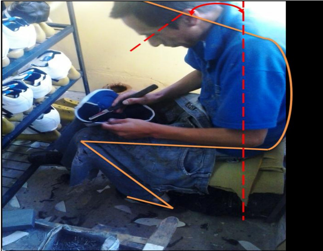
Fig. 39: Proceso de puesta de pega en el corte (Calzado JOSMAX).
