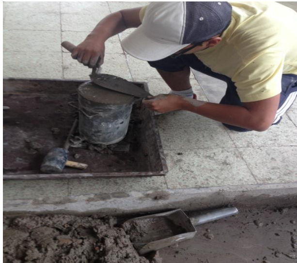
Fotografía N° 15.- Toma de muestras hormigón a base de ladrillo.
