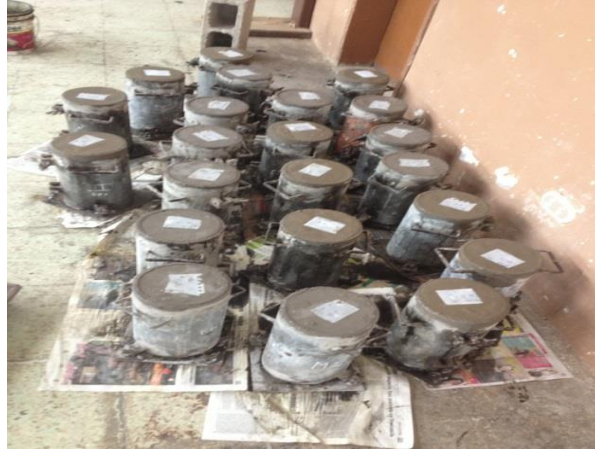
Fotografía N° 17.- Tiempo de fraguado de las probetas de hormigón a base de ladrillo.
