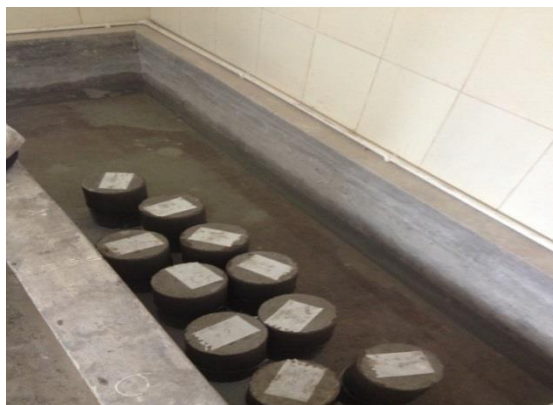
Fotografía N° 18.- Curado de las probetas de hormigón a base de ladrillo.
