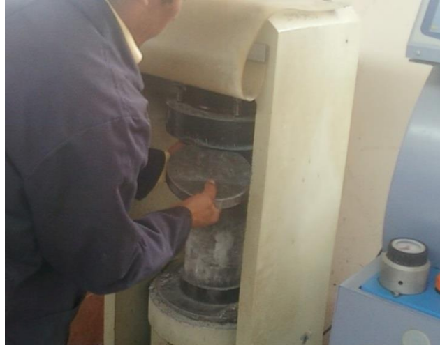
Fotografía N° 19.- Probeta ubicada en la máquina de compresión.
