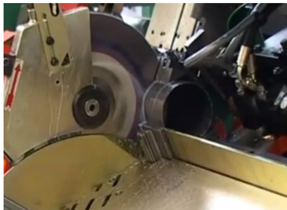
Figura 2-21 Proceso de corte mediante disco de sierra.
