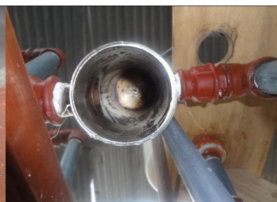
Nótese de la inexistencia de partículas contaminantes adheridas a las paredes internas del cilindro.
