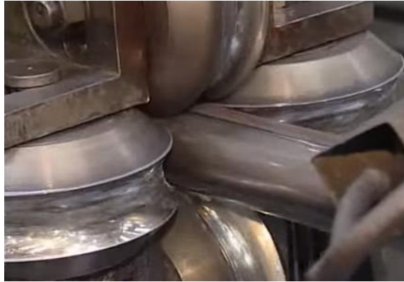
Figura 2-20 Calibración de dimensiones (Bancada Calibradora)
