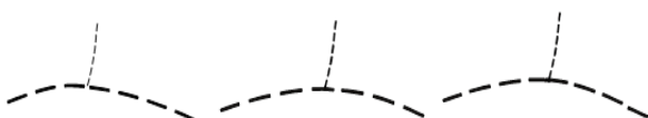
Fig. 15a: Con vértice normal; Fig. 15b. Con vértice de segmento; Fig. 15c. Con vértice de esquina
