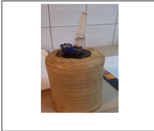
Imagen N° 12. Medición del calor específico.
