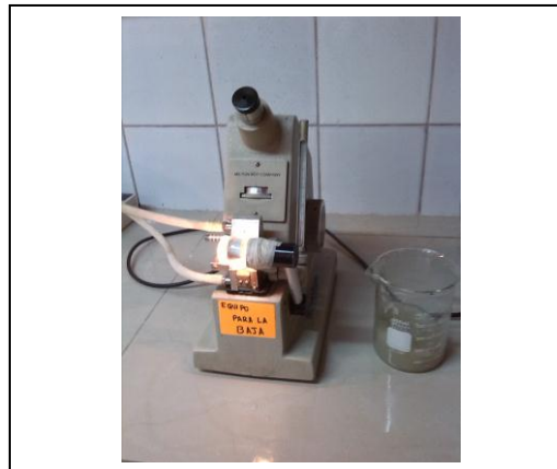
Imagen N° 10. Medición del índice de refracción.
