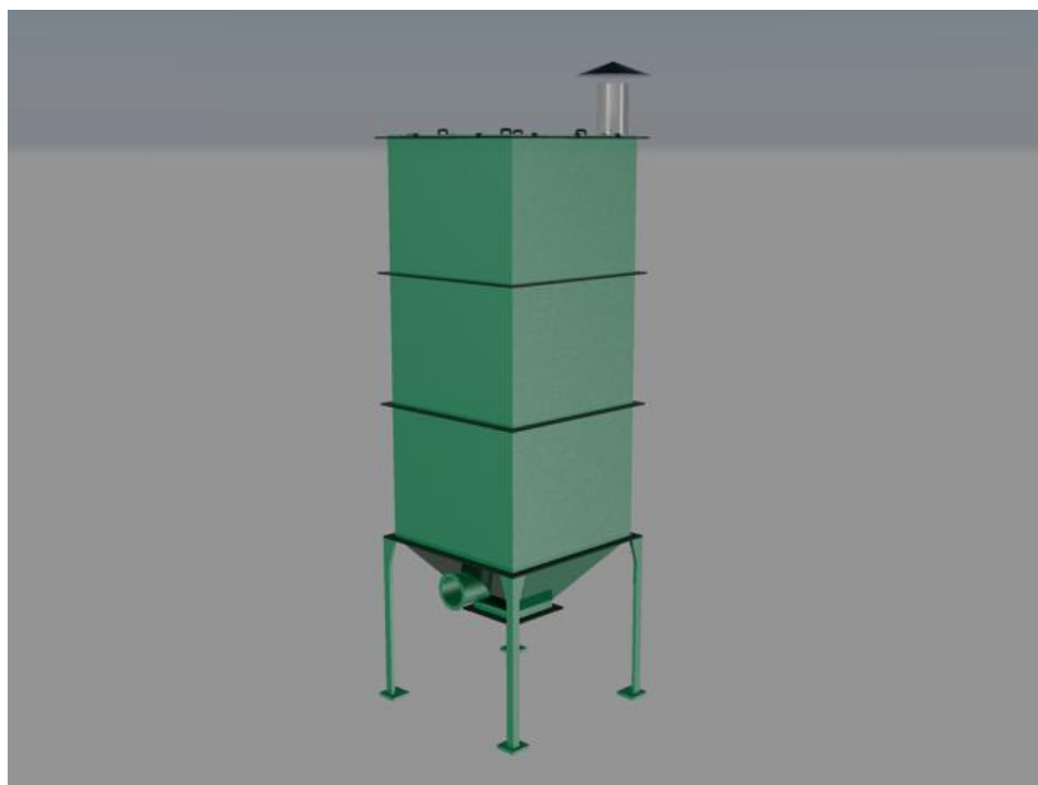
Figura 6.34 Modelado en 3D del filtro de mangas
